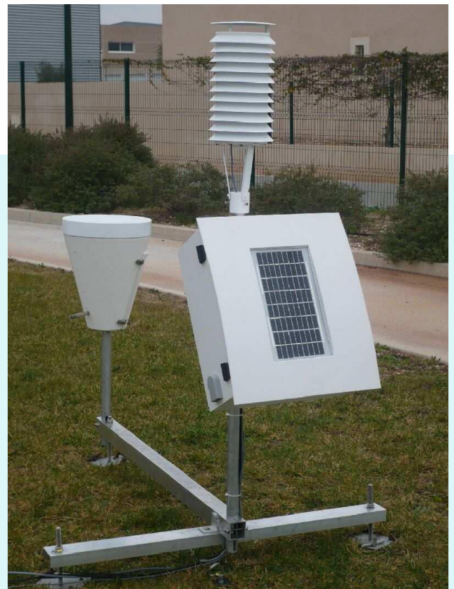
Exemple d'intégration : station autonome Pluie, Température, Humidité
