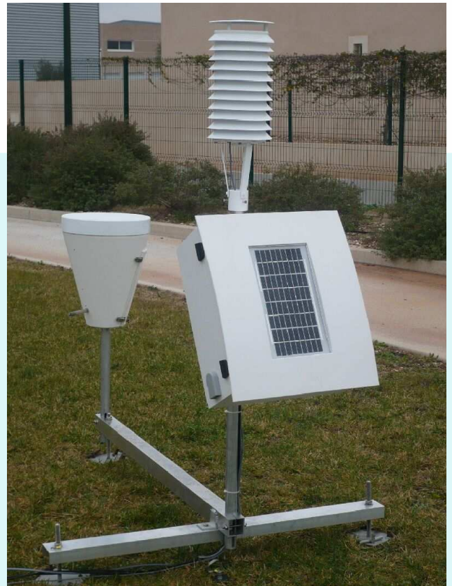
Exemple d'intégration : station autonome Pluie, Température, Humidité
